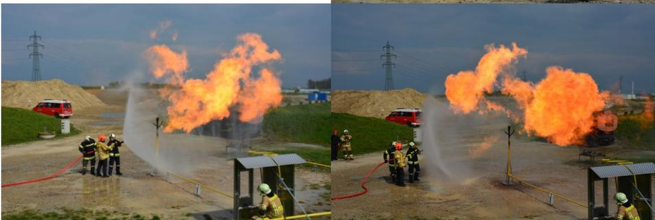
Ein nach allen Seiten ausströmendes Gas wird mit Sprühstrahl zurückgedrängt.
